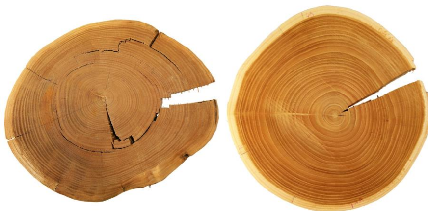
Fig. 1: Effetto del ritmo di crescita sulla cipollatura del castagno sinistra: rotella di castagno cresciuta irregolarmente e fortemente cipollata destra: rotella cresciuta in modo sostenuto e regolare e priva di cipollatura
